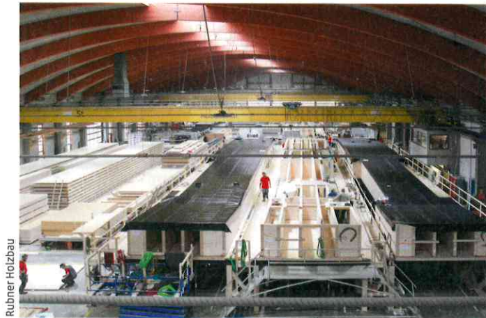
Werkseitige Vorfertigung der Hohlkasten-Elemente samt Notabdichtung auf drei aufgebockten Montageplätzen. Die erhöhte Position gewährleistet einen optimalen Zugang für alle Arbeitsschritte und ermöglicht das direkte Unterfahren und Ablassen der Elemente auf den LKW-Anhänger.
